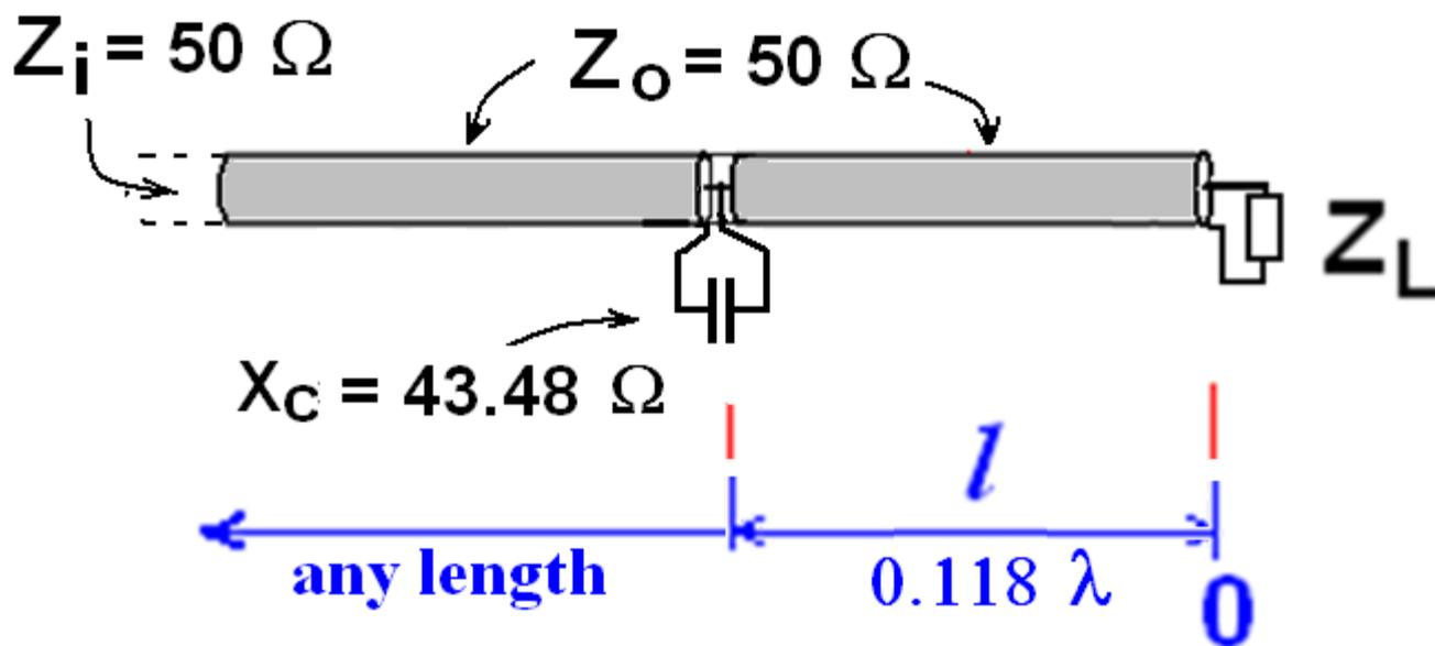
Al posto del condensatore di  $X_C = 43.48 \Omega$  si può utilizzare uno spezzone di cavo lungo meno di  $1/4$  d'onda, aperto all'altra estremità (se in corto circuito si comporterebbe come una induttanza) di opportuna lunghezza  $l_1$ .
