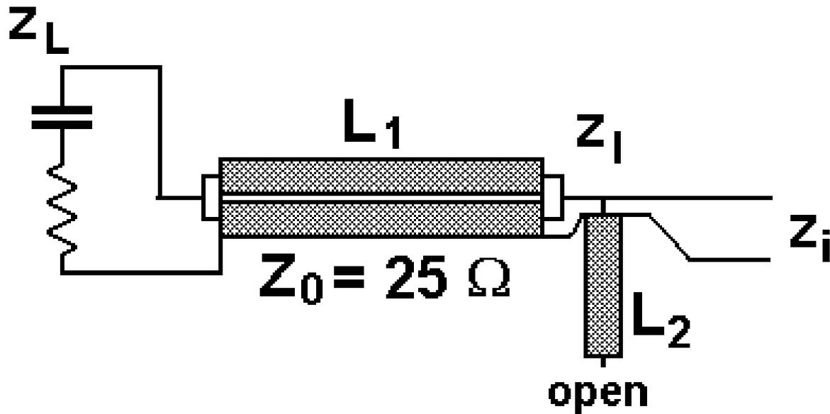
Lo stub parallelo con  $b = +j 0.806$  (normalizzata a  $25 \Omega$ ) è ottenuto con cavo di lunghezza  $L_2$ .
