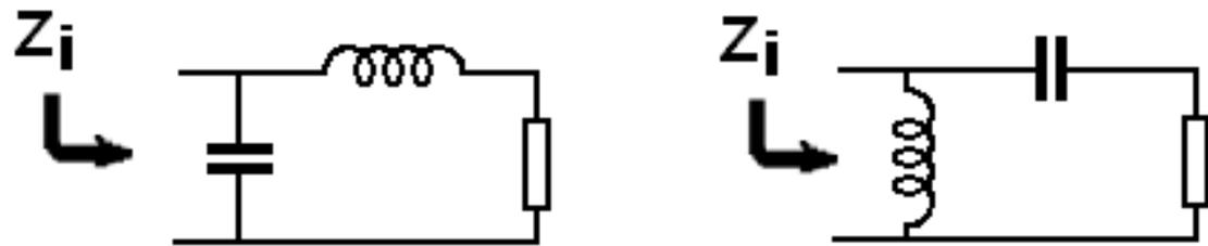
non possono essere utilizzati con i valori di  $z_i$  e  $z_L$  di questo esempio perché le circonferenze  $r=1$  (passaggio da  $z_L$ ) e  $g = 1.67$  (passaggio per  $z_i$ ) non si incontrano.
