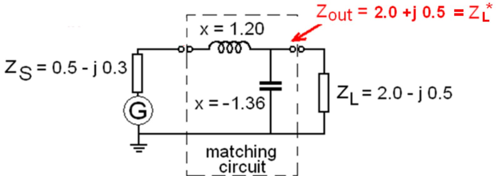
In questo caso, l'impedenza di uscita del circuito di matching dovrà essere complesso-coniugata dell'impedenza del carico  $Z_L$ .
