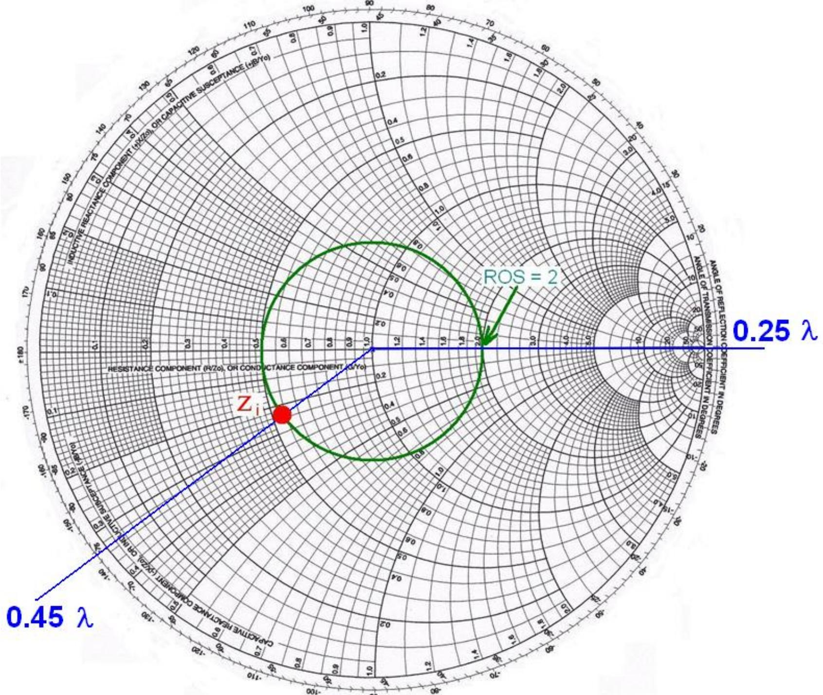
Con ROS = 2, l'impedenza normalizzata del carico (antenna) può essere  $z_L = 2$  oppure  $z_L = 0.5$  (indicate con  $z_{L1}$  e  $z_{L2}$ ), ovvero l'impedenza ai morsetti dell'antenna è  $Z_L = 100 \Omega$  oppure  $Z_L = 25 \Omega$ .
