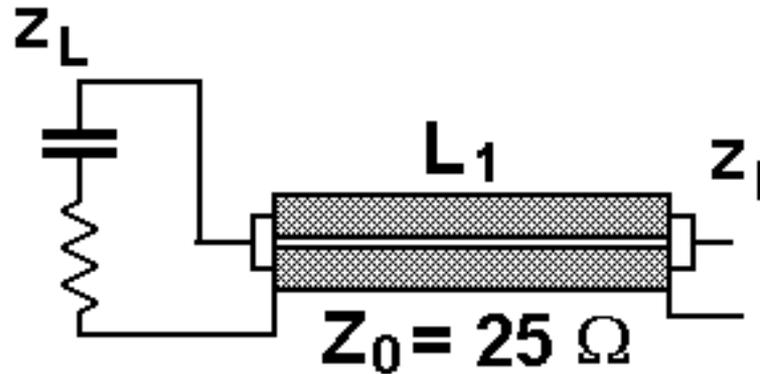
La lunghezza dello spezzone  $L_1$  è ottenuta direttamente dalla Carta osservando la gradazione in lunghezze d'onda sul bordo.
