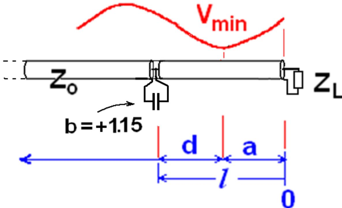
La suscettanza normalizzata  $b = 1.15$  (capacitiva), una volta de-normalizzata, diviene:  $B = b / 50 = 0.023$  mho.
