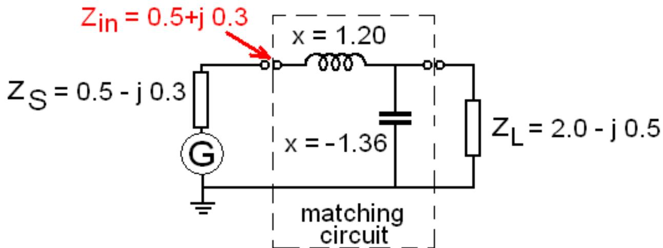
L'impedenza di ingresso del circuito di matching  $z_{in}$  deve essere complesso-coniugata dell'impedenza  $z_s$  della sorgente.
