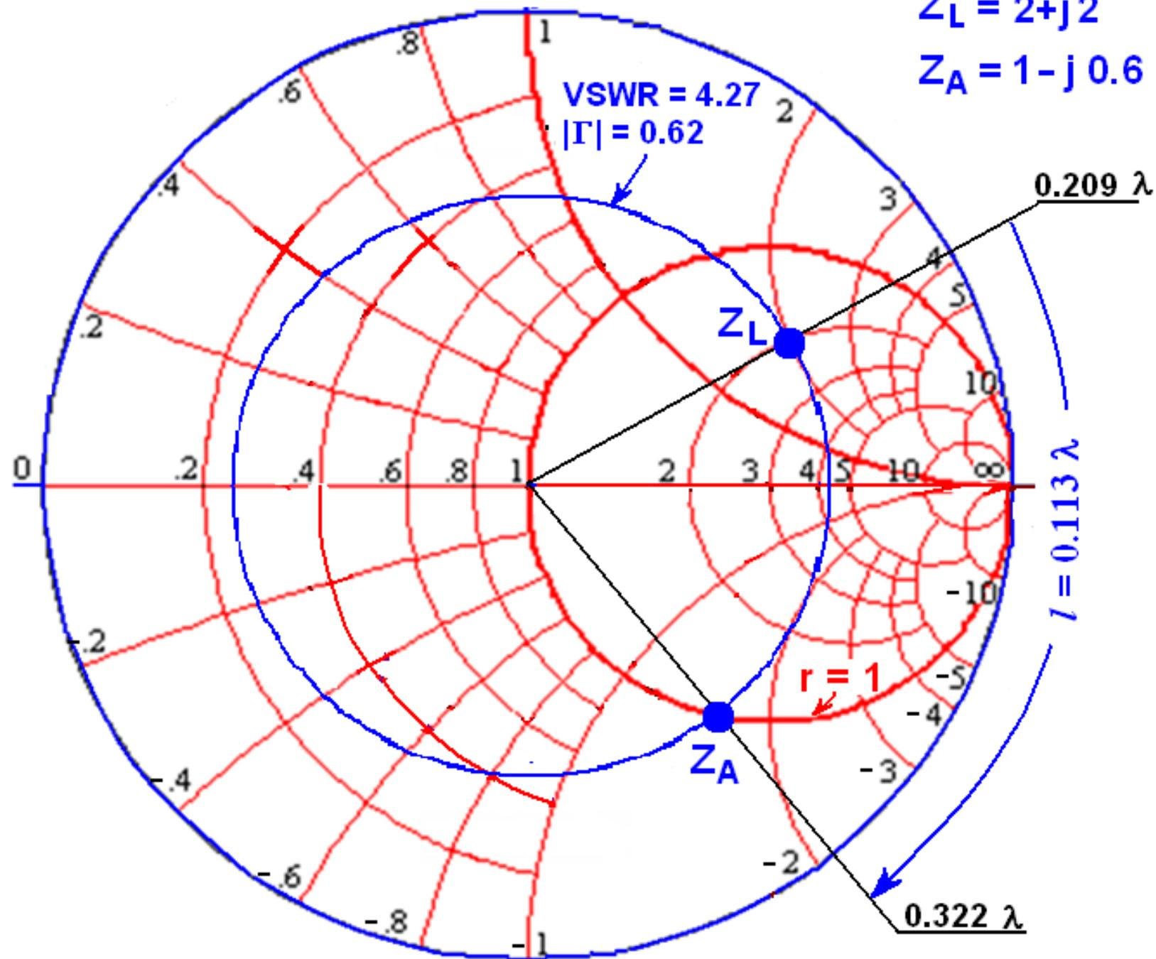
Stub e carico sono posti in serie. Si utilizzerà la Carta di Smith delle impedenze.
